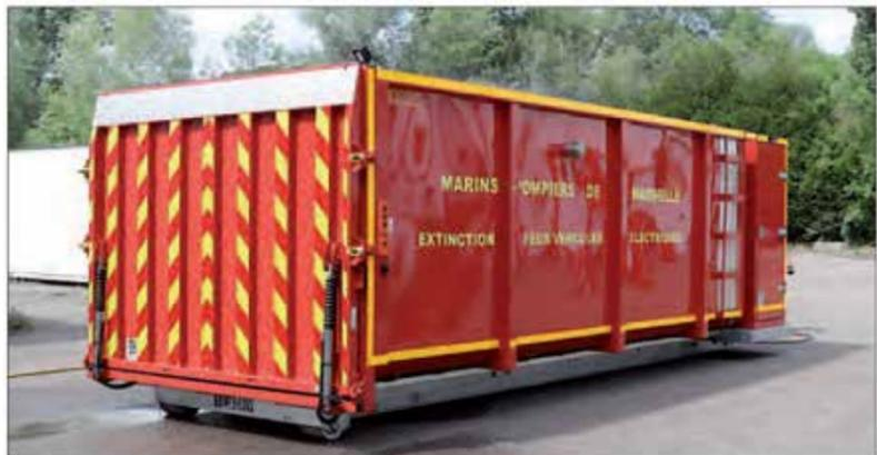
BEHM SAS, première cellule d'intervention française spécialement destinée à l'extinction de feux pour des véhicules électriques. (© BEHM)
